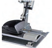
付属のスライド式アタッチメントにフェース角測定器が固定されており、操作性、正確性が高い。
