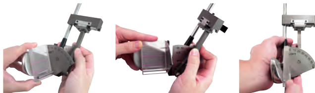
ライ角測定用分度器と、フェースプログレッション測定には、最小目盛り以下の数値を読み取る補助をしてくれる、バーニア目盛りを採用。
