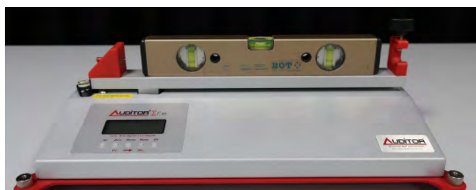
左右方向の水平確認
