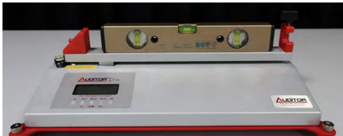
左右方向の水平確認
