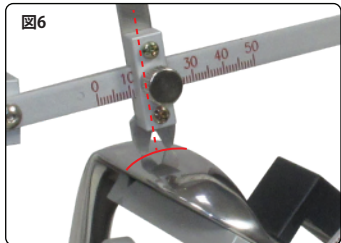
図6 ソールのラウンドが大きい場合は、リーディングエッジ用ゲージを逆に装着し、2点ゲージがソール中央に合致するように当て、バウンス計測。
