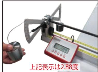
片側だけの錘の負荷により、シャフトがねじれ、静止した状態で、コントロール・ユニットに表示された数値がトルク値(度)になります。数値が安定しない場合は、各クランプが滑っていないか、再度、ご確認ください。
