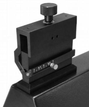
シャフト切断前の測定では、想定レンジで切断した場合のクラブのグリップエンド(グリップのエンドキャップ厚も考慮して下さい)が、クランプ長の左端と一致するように、クランプして下さい。クランプ長左端の目安として、エンドプレート取り外し後の保持棒をご利用下さい。この時、カットしたグリップ等をシャフトに被せてクランプし、擬似的にグリップ挿入後の振動数を算出することも可能です。但し、カットしていないシャフト重量や、グリップの密着性等の要因から、実際に完成したクラブと多少の誤差が生じますので、ご注意下さい。
