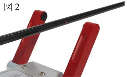
シャフトにヘッドが装着されている場合、測定する際の位置としては、多くのクラブメーカーがヘッドのトゥが地面を指す位置を用いています。
