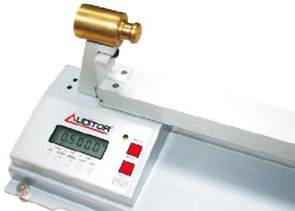
※キャリブレーションを開始する前に、計量用ビームを取り付けてある場合は、必ず、取り外して下さい。
