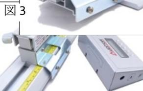
次にユニットの前側にあるアクセス穴を通してネジを軽く締めこみます。ユニットのハウジング内の配線を傷つけないように注意してください。ネジを締めすぎると、ロードセルアッセンブリがトラック上でスムーズに動かなくなりますので、締めすぎないでください。(図 4)
