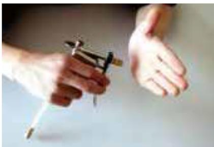
ポンプを数回押して空気が出ているか、チェックをして下さい（左図参照）。次に、ホースを取り付ける前の噴霧用の初期状態で、ポンプを溶剤を入れた本体タンクにセットし、溶剤が噴射できるか確認します。
