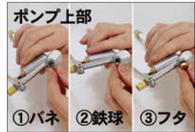
ポンプ上部の真鍮ボルトへは、バネを先に装填し、鉄球を最後に戻し、元通りに真鍮ボルトを取り付けます。ポンプを本体に戻し、溶剤が噴射できるか、再度確認します。空気は出るのに吸い上げない場合は、チェック4の作業を行って下さい。
