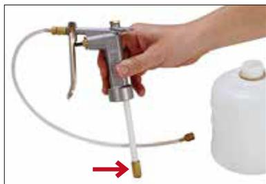
ポンプを本体から外し、ポンプに付帯するストロー部末端の真鍮部を数回叩く。
