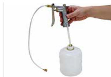
ポンプを本体へ戻し、溶剤が噴射できるか再度確認します。50回以上の吸い上げで、溶剤が噴射されない場合は、お手数ですが、更に次頁のチェック3の作業を行って下さい。
