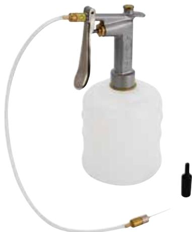
グリップを切らずに抜き取るために、グリップとシャフトの隙間に溶剤を送り込むポンプ式注射器。ホース先端の針をグリップに差し込み、溶剤を送り込むことで、両面テープのノリを溶かし、抜きやすく、グリップの再利用（リグリップ）がスムーズに行える工具。
