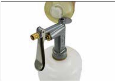
チェック3ご参照の上で、ポンプ上部の真鍮ボルト部品を外し(バネと鉄球の紛失にご注意下さい)、溶剤を鉄球が浸るまで注ぎ、レバーをゆっくり数回引きながら、溶剤が吸い込まれず、溢れてくるようになるまで充填します。
