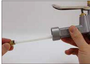
ストロー部末端の真鍮へは、鉄球を先に戻し、最後にバネ(鉄球側が狭い側です)に戻し、元通りに真鍮部品を取り付けます。
