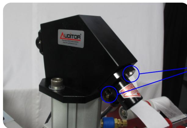
電源アダプターをコンセントに繋ぎ、クラブやシャフトをクランプして、レーザーの位置を確認します。
