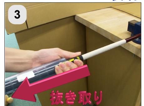
3 グリップ先端側を指で塞ぐ等、空気が満遍なく行き渡らせたなら、空気を送り込みながら、ゆっくりグリップを引き抜きます。
