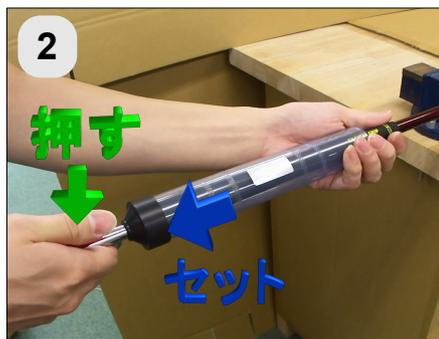
2 本体に、プラスチックカバーをセットして、グリップ先端側を指で押さえながら、本体の操作レバーを少しずつ押して、空気を送り込んでいきます。
