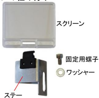
Step-9: 万の cutter・ブレードの破損や、シャフト片の飛散等による怪我を防ぐため、ブレードの前面にセーフ・スクリーンを組み付けます。ブレードのカバーにある螺子孔に、付属の螺子とワッシャーでステアを固定します(図14)。ステアの黒いプラスチック部に、スクリーンをはめ込み、ブレードやポリッシング・ガイドに干渉しない範囲で、ステアとスクリーンの角度を調整して下さい(図15)。
