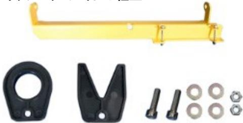
Step-4: 上図のパーツを利用して、ポリッシング・ガイドを組み立てます。ガイド・フレームに、V字ガイドとリングガイドをボルト、ワッシャー、ナットを使用して固定します。13mmスパナ等と付属の六角レンチを併用して、V字ガイドがサンディング・ベルト側となるように組み付けて下さい。ワッシャーはボルトとナットに触れるよう、外側双方に挟んで締め込みます。ガイドを取り付ける向き等は、図5を参考にして下さい。
