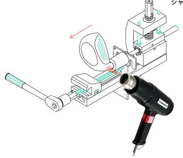
プーラーがヘッドを引き抜く力を少し加えた状態で、 再度、ヘッドのシャフト挿入部分を満遍なくヒート ガン等で加熱します。この時、ソケットを傷めない ようにご注意下さい。
