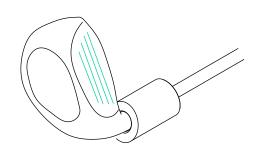
ヘッド抜き工具にクラブのヘッド部を固定し、本商品を ヘッドとヘッド抜き工具のプーラー部の間にセットして、 ヘッドの上面にしっかりと密着させます。 こうすることで、プーラーに押された本商品がヘッドを シャフトから引き抜きます。
