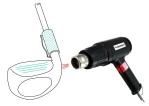
ヘッドのシャフト挿入部分を満遍なく ヒートガンで加熱し、接着剤を溶融させます。 こうした特殊なネックのクラブは、比較的溶融しにくい 接着剤を使用している場合もあるため、十分に加熱をして 下さい。
