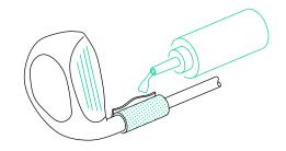
ソケットの溶解を防止するため、セーム革 をホーゼル部分に巻き付け、水で湿らせます。
