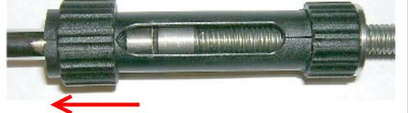
ソケットがフレーム内部に完全に収まったら、ロック・リングをフレームのキャプチャー部までスライドさせます。こうすることで、キャプチャー内側のつばがソケットを保持します。ノブを回して、ボルト・キャップを徐々にシャフト・チップ端に当て、さらに回し続けることで、ソケットをシャフト・チップ方向にスライドさせます。
