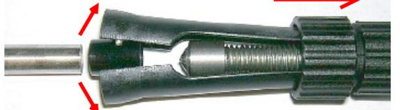
ソケットがシャフトのチップ端近くまでスライドしたら、ロック・リングをノブ側にスライドさせて、フレームを開いて抜き取るか、ボルト・キャップがソケットに触れるまで、スライドさせてから機器を外すと、さらに容易に抜き取ることが可能です。
