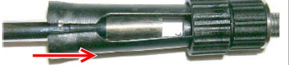
フレームを開いて、シャフトのチップ端を挿し込みます。ソケットがフレーム内部のキャプチャー部より内側に入るようにセットして下さい。
