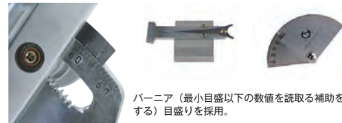
付属のスライド式アタッチメントにフェース角測定器が固定されており、操作性、正確性が高い。
