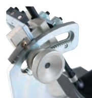
ライ角用スライドノブは回しやすく微妙な調整が可能。位置を固定するロックノブもスライドノブと連動し、確実に誤作動もない。
